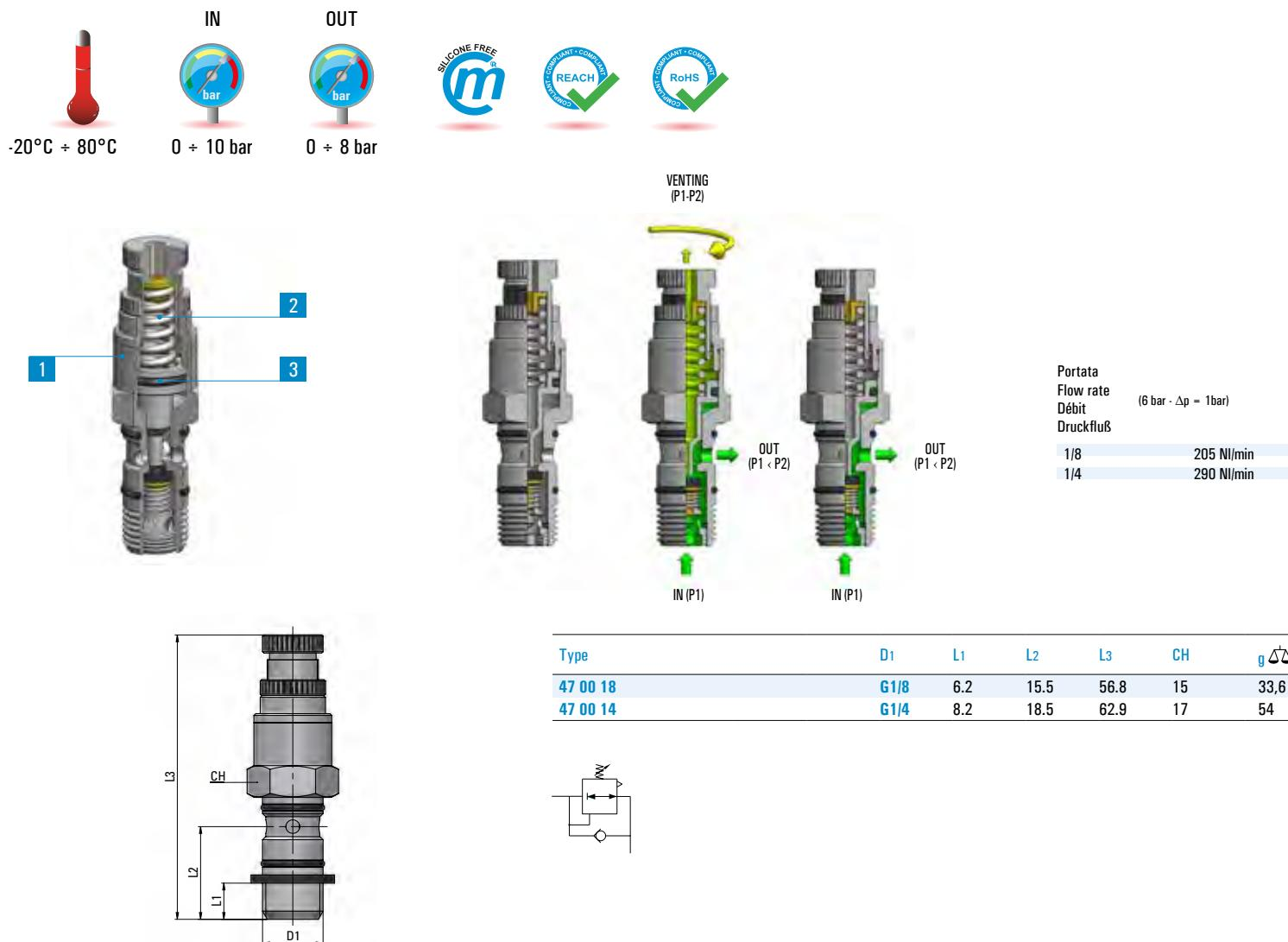
Installati in un circuito pneumatico permettono di regolare la pressione di lavoro delle attrezzature collegate, mantenendo tale regolazione costante nel tempo. Particolamente interessante è l'applicazione come Economizzatore, che si ottiene collegando il regolatore tra la valvola ed il cilindro da comandare. In questo modo è possibile ottenere una riduzione di pressione e di velocità dello stelo in un unico senso (quello desiderato), contenendo così il consumo d'aria da parte del cilindro.
